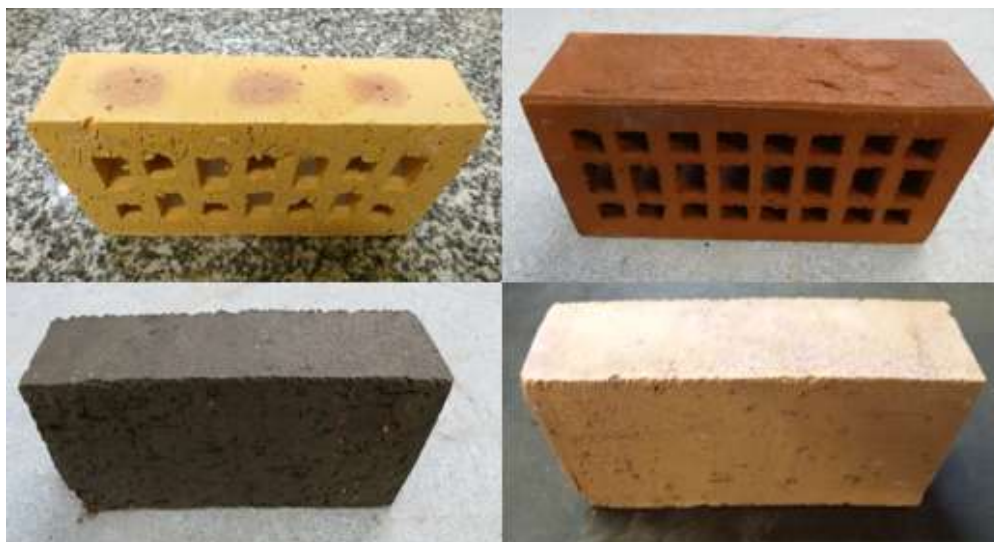
Figure 3 - Exemples de briques de type U – En haut, briques apparentes perforées ; en bas, briques apparentes pleines
