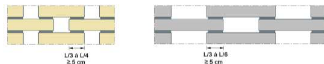
Figure 8 - Recouvrement des briques standard et briques de grandes dimensions
