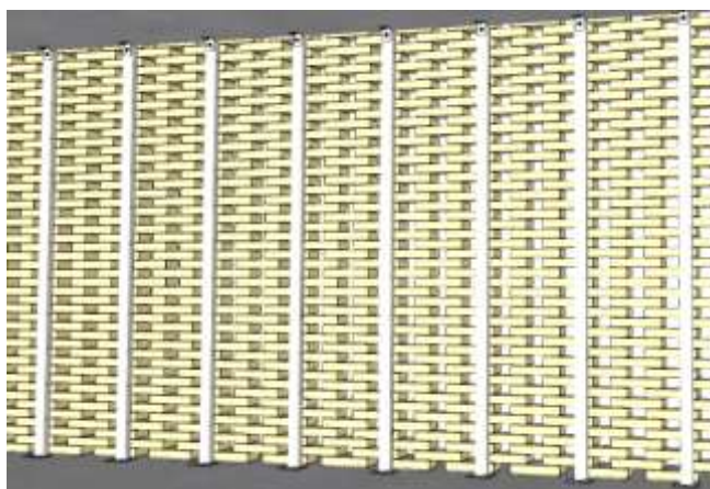
Figure 15 - Moucharabieh assujetti à des potelets métalliques en face arrière
