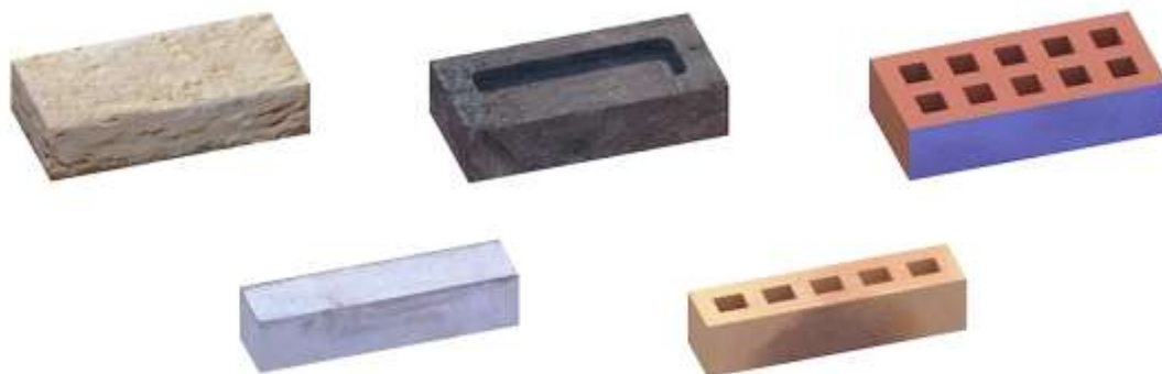
Figure 2 - Exemples de briques et mulots de type U
