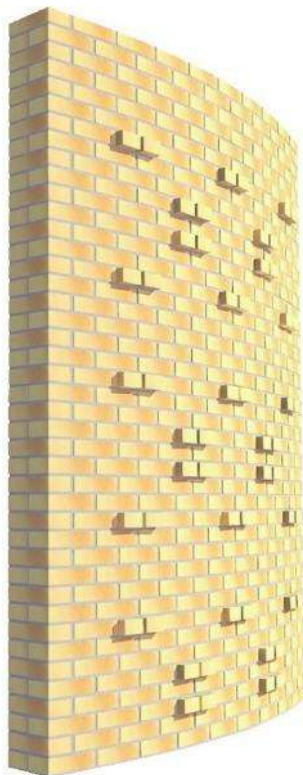
Figure 54 - Mur en courbe avec disposition de briques en saillie
