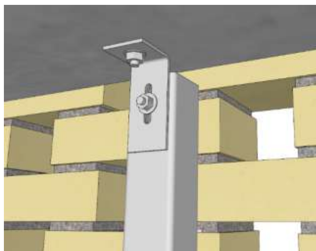
Figure 18 - Fixation en tête d'un potelet de renfort
