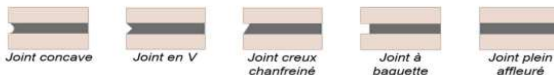
Figure 6 - Profils recommandés de joints épais
