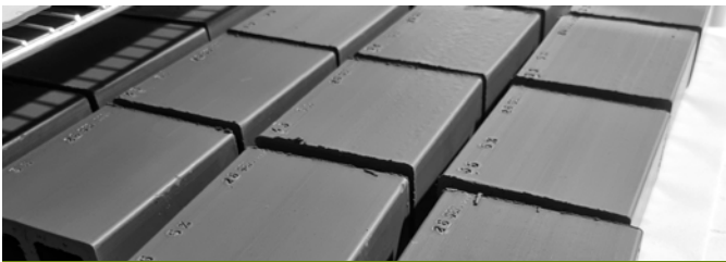
Exemple de briquettes extrudées au laboratoire de Limoges
