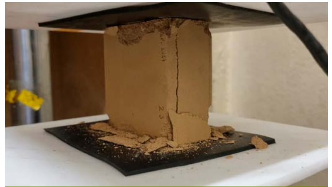
Exemple d'essai de compression sur de la terre crue
