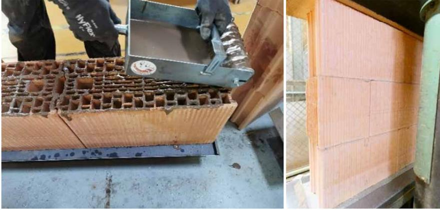
Figure 1 - Muret monté à joint mince pour l'essai de résistance à la compression (cf. NF EN 1052-1 : 1999)
