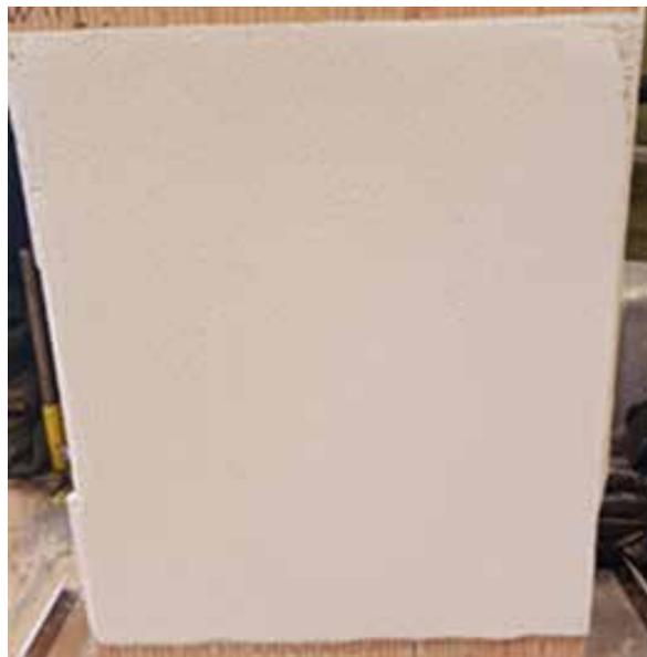
Figure 2 - Muret mis en œuvre avec des briques présentant des fissures préexistantes, enduit
