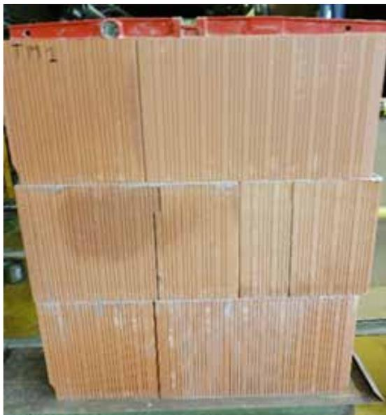
Figure 1 - Muret monté avec des briques choisies avec des fissures préexistantes
