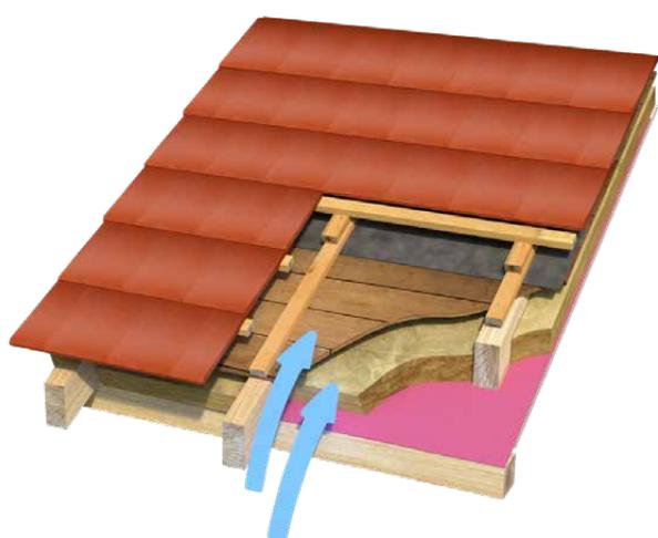
Schéma 3D de la mise en œuvre des tuiles avec le système de double ventilation sur support continu
