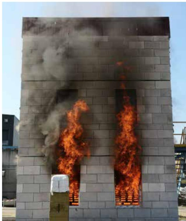
Essai feu « LEPIR II » réalisé sur une configuration générique de procédé traditionnel de revêtement mural en pierre mince attachée selon le NF DTU 55.2
