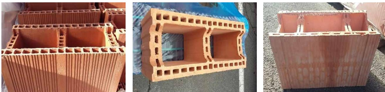
Figure 1 - Trois types de briques à bancher pris en compte dans le dossier d'ATEX
