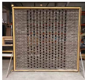
Figure 2 – La maquette de moucharabieh ordinaire (sans renforts) ayant servi pour l'essai de résistance au vent en dépression réalisé en 2023
