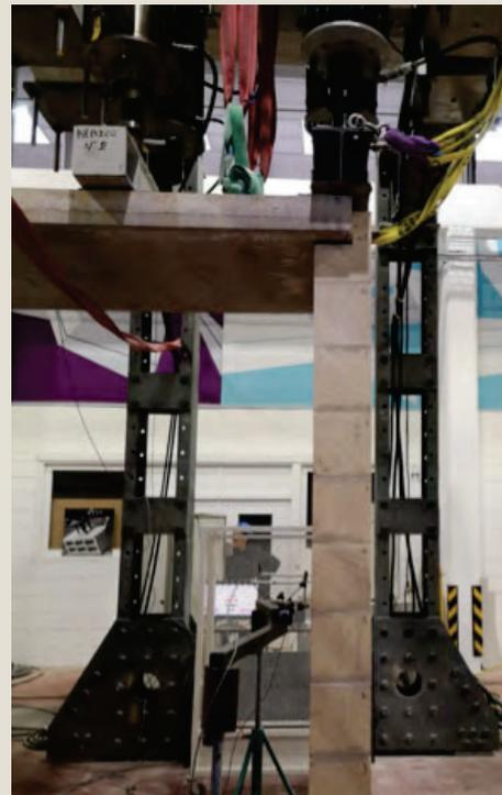
Réalisation de l'essai : chargement mécanique du mur de rive jusqu'à rupture (Photo CTMNC)
