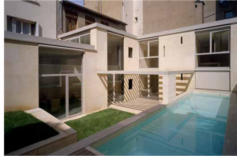
Maison-galerie à la Croix-Rousse (69) Les apports de lumière, l'exposition, la conception limitant l'utilisation d'isolant sur les murs, le double-mur.
