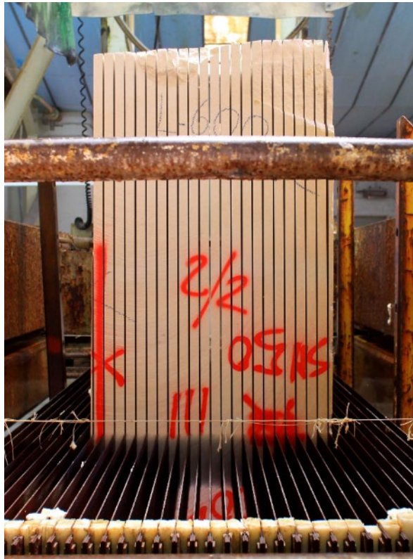
Sciage châssis multilâmes ROCAMAT
