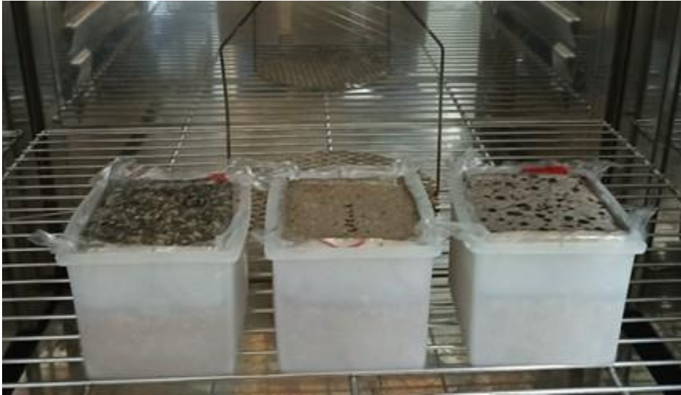
Figure 48 - Trois pavés en cours de mesure dans l'enceinte climatique
