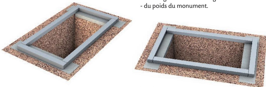
Figure 3. Fondation/assise simple par longrines à l'avant et à l'arrière
