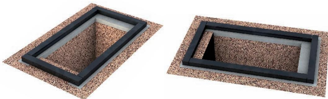
Figure 4. Fondation/assise simple par longrines sur les 3 côtés
