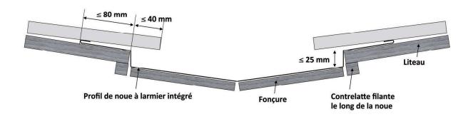
Figure 1 : Noue à larmiers intégrés (développé de 500 mm)
