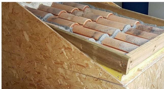
Banc d'essai de perméabilité à l'air des couvertures - en cours de construction
