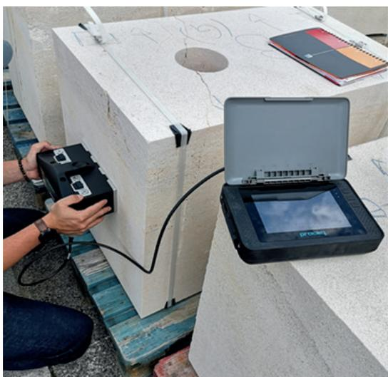
Figure 2 - Dispositif de mesure expérimentale à l'aide du « Pundit 250 Array » : détection de la profondeur et du positionnement d'une cavité dans un bloc de pierre
