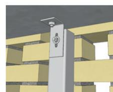
Figure 2 - Moucharabieh assujéti à des potelets métalliques en face arrière
