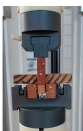
Dispositif d'essai d'arrachement - Croix
