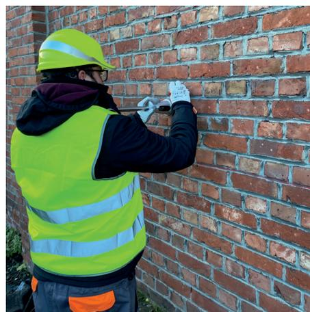
Réalisation d'un essai non destructif pour évaluer l'aptitude au réemploi des briques
