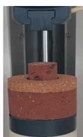
Dispositif d'essai d'arrachement - Disque
