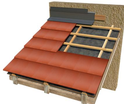
Schéma 3D du traitement d'un point singulier en climat de montagne : traitement de rive de tête avec dépassement vertical du mur
