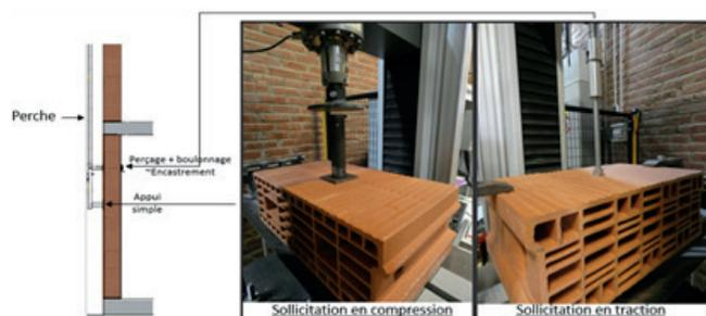
Figure 1 - Illustration d'une configuration d'essais de chargements localisés (en traction ou en compression)
