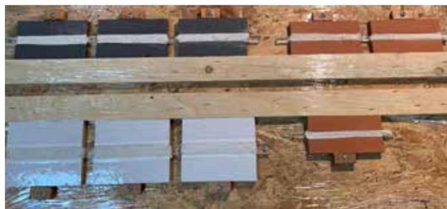
Exemple de maquettes d'essais à base de plaquettes de terre cuite avec différentes largeurs et qualités de joints
