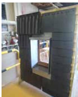
Maquette de l'entourage d'une fenêtre avec un bardage en tuiles
