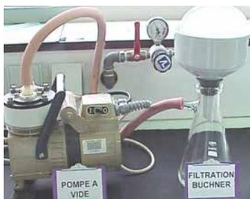
Photo 1 - Essai de rétention d'eau sous vide
