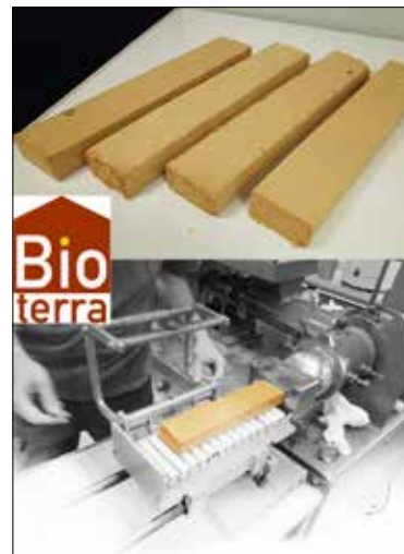
Extrusion de briquettes en terre crue avec ajout de fibres biosourcées
