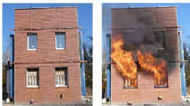
Exemple de propagation du feu d'étage en étage (essai LEPIR 2)
