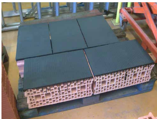
Sur briques P revêtues d'un enduit bitumineux
