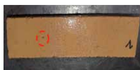
Brique A à l'issue de 25 cycles de gel/dégel selon l'Annexe D de la NF EN 771-1/CN
