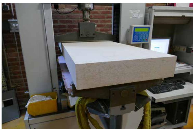
Test de rupture à la flexion sur grande dalle de pierre naturelle réalisé au CTMNC
