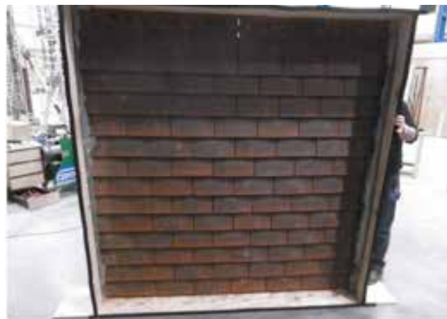
Dispositif de tuiles en bardage testé au vent
