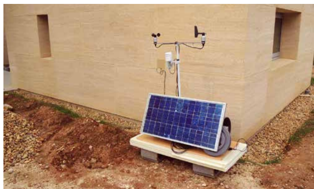
Centrale d'acquisition des mesures
