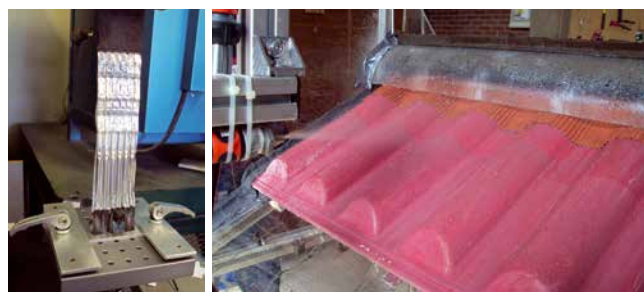
Essai de traction du cordon adhésif
