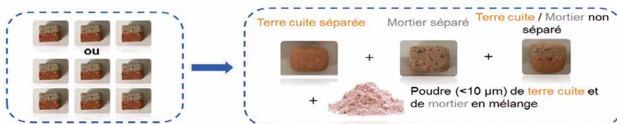
Echantillons de déchets composites avant et après séparation (exemple du mortier)
