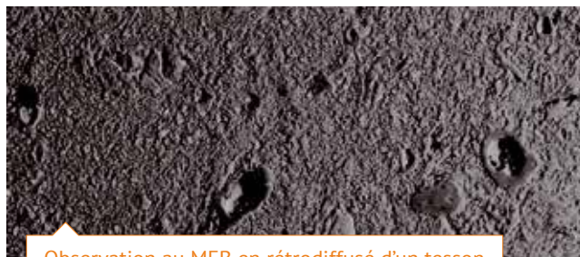
Observation au MEB en rétrodiffusé d'un tesson contenant de l'oxyde de lithium
