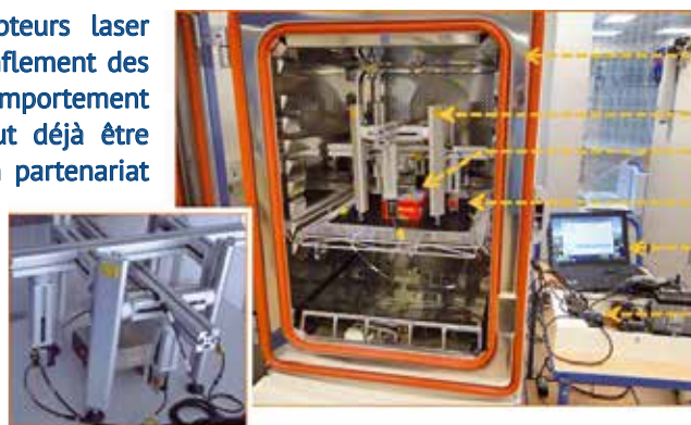
Montage de l'essai de retrait/gonflement par capteurs laser
