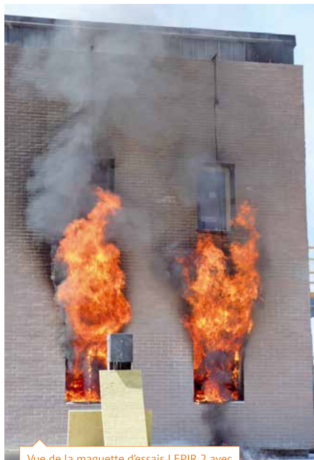
Vue de la maquette d'essais LEPİR 2 avec revêtements en plaquettes de terre cuite
