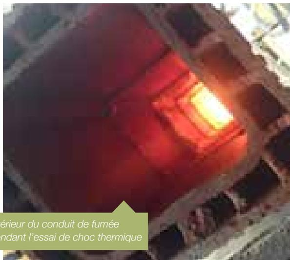
Intérieur du conduit de fumée pendant l'essai de choc thermique
