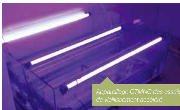
Appareillage CTMNC des essais de vieillissement accéléré
