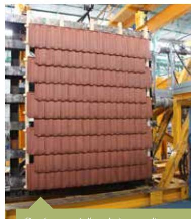
Bardage en tuiles de terre cuite sur le banc d'essai sismique du CSTB à Champs-sur-Marne
