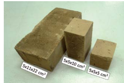
Les différents formats d'éprouvette envisagés pour l'essai de résistance à la compression.
