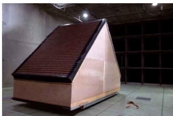
Maquette bi-pente à 45° couverte de tuiles plates dans la soufflerie (source CTMNC)
