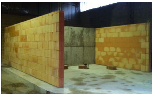
Photos 1 et 2 – Maquettes en H destinées à la détermination des affaiblissements vibratoires K_{ij} pour des jonctions refend/façade en ITI et en ITE
