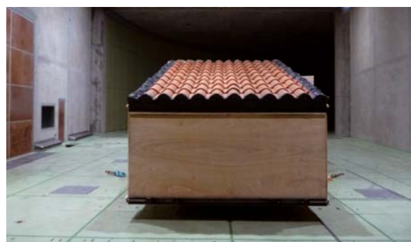
Maquette de pente 15° couverte de tuiles à emboitements fortement galbées (source CTMNC)
