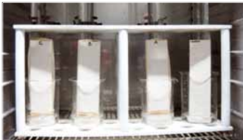
Dispositif de l'essai de compatibilité entre le produit de collage ou le mortier de jointoiement et la pierre naturelle selon l'annexe A de la norme NF DTU 52.2 P1-2 (décembre 2009)
