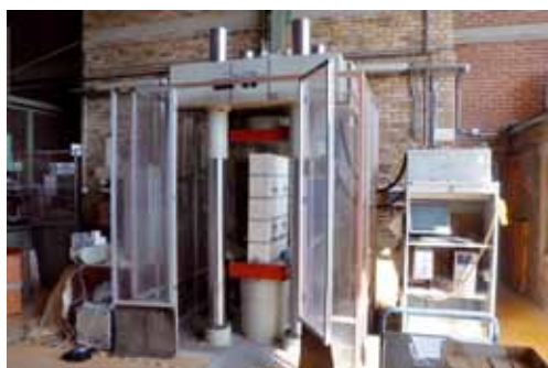
Dispositif d'essai de compression sur murets en pierres naturelles
