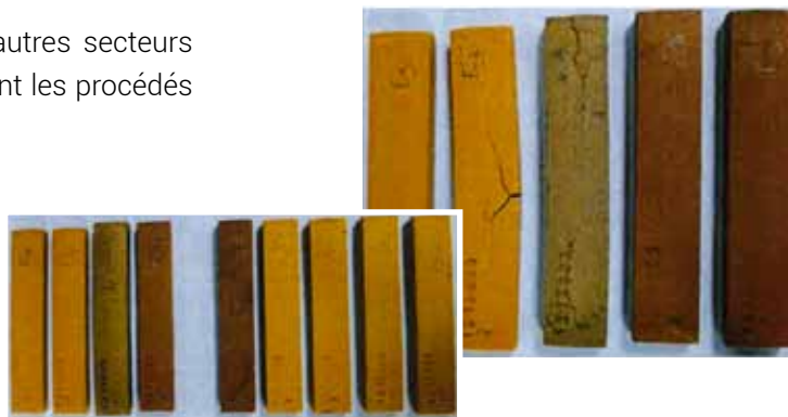
Différentes barrettes séchées selon des procédés micro-ondes ou hautes fréquences
