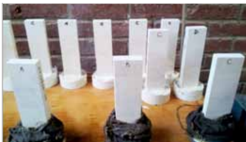
Dispositif de l'essai de Venuat.
