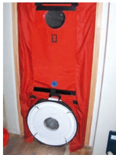
Porte soufflante du CTMNC pour la mesure de perméabilité à l’air de bâtiment
