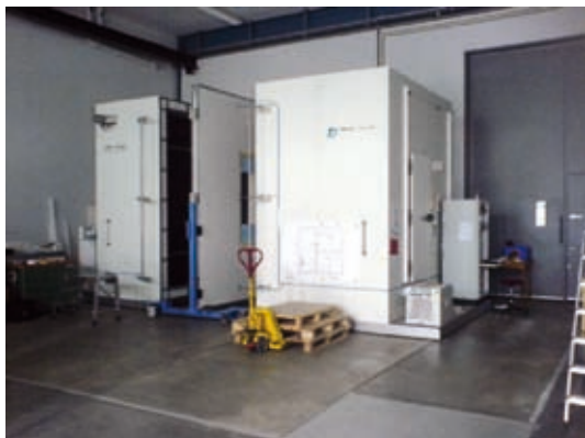
Equipement de l’EMPA pour les mesures de performances thermiques de murs
