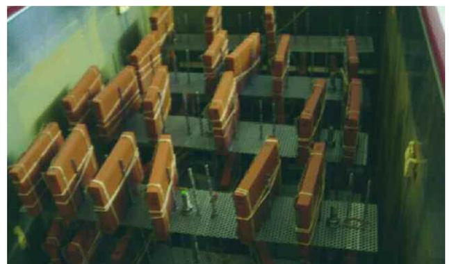
En 2008, les essais de gel terminés permettront d'affiner le code thermo-hydro-mécanique et d'élaborer un outil de prédiction de la résistance au gel de tesson de caractéristiques connues.
