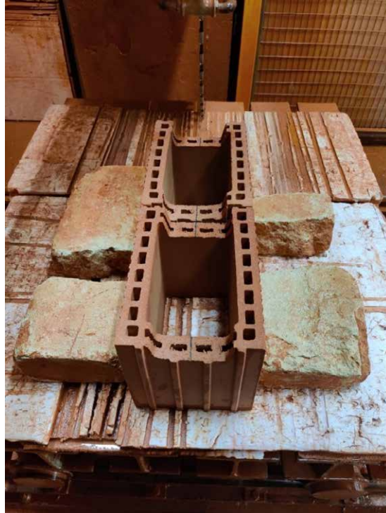
Figure 1 - Préparation des échantillons pour les essais de flexion sur parois de briques à bancher
