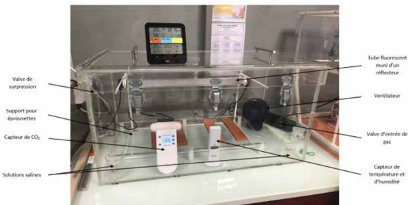
Description de la « CO 2 Box », développée par le CTMNC pour évaluer la capacité des produits de terre cuite à capter le \text{CO}_2 atmosphérique
