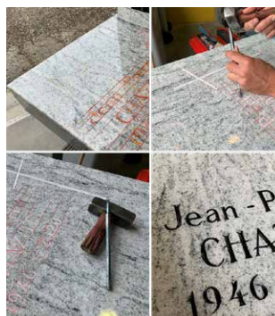
Aperçu des étapes d'une gravure manuelle sur marbre funéraire (Droits photo : Marbrerie Roth)
