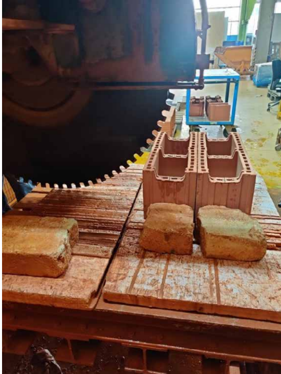
Figure 1 - Préparation des échantillons pour les essais de flexion sur parois de briques à bancher
