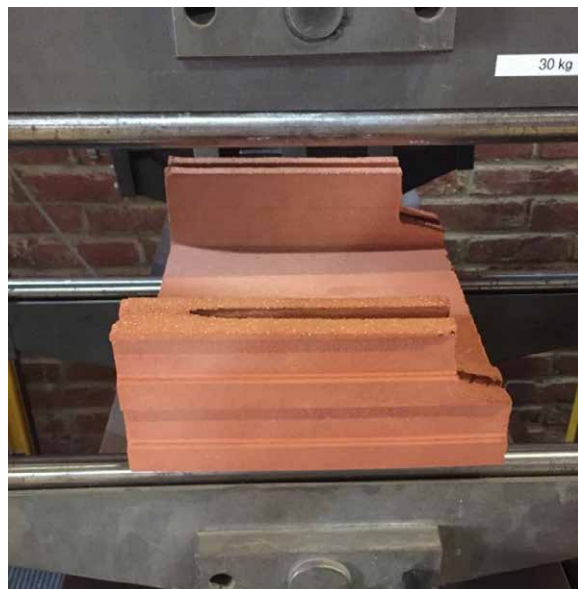
Figure 2 - Essais de flexion 3 points sur parois de briques à bancher
