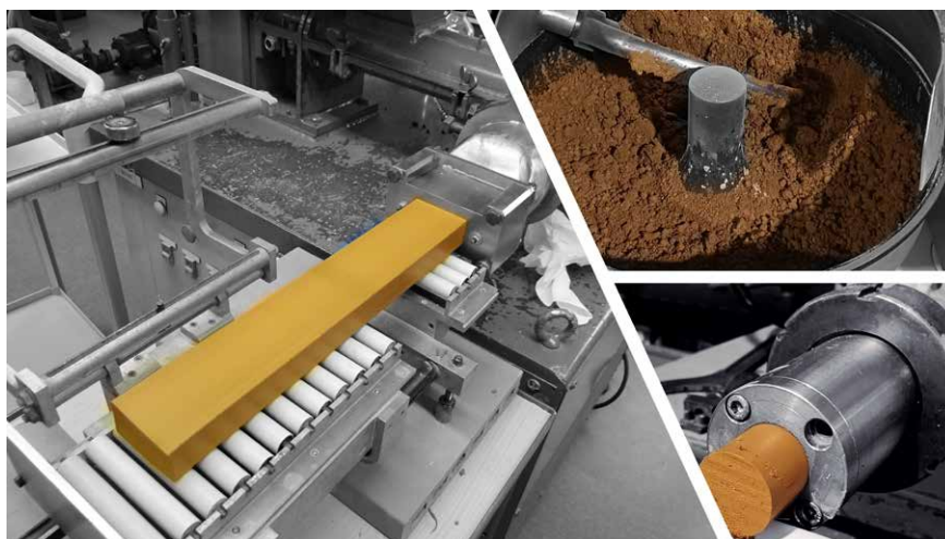
Extrusion d'éprouvettes de terre crue réalisée au laboratoire du CTMNC de Limoges
