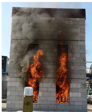
Maquette en pierre naturelle (calcaire) soumise à l'essai LEPIR II réalisé par Efectis en mars 2022
