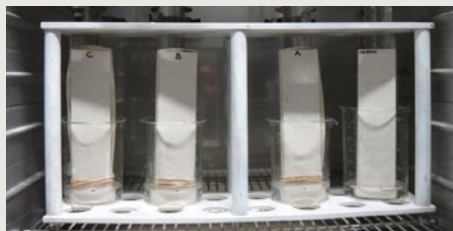
Dispositif de l'essai de compatibilité de l'annexe A de la NF DTU 52.2 P1-2
