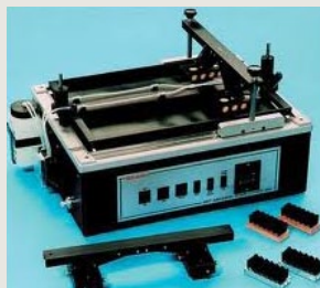
Appareillage d'essai de frottement humide, conformément à l'ISO 11998 (Crédit Photo : Labomat essor)
