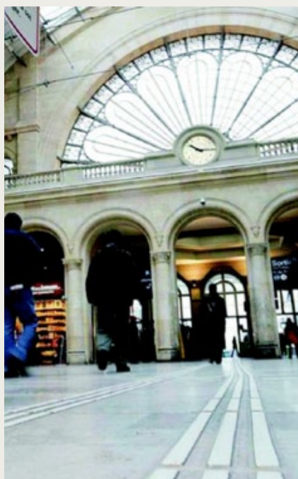
Gare de l'Est, Paris Bandes de guidage Photo issue du document Certu/CETE Lyon, 2010
