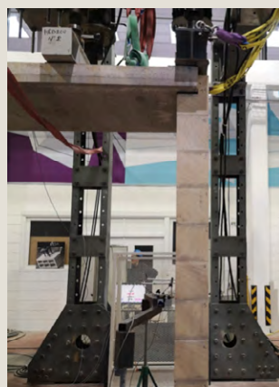
Réalisation de l'essai : chargement mécanique du mur de rive jusqu'à rupture Photo: CTMNC
