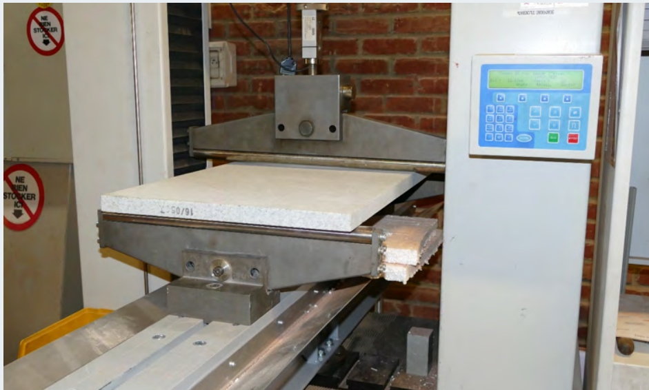
Exemple d'un essai de flexion sur dalles - Photo CTMNC
