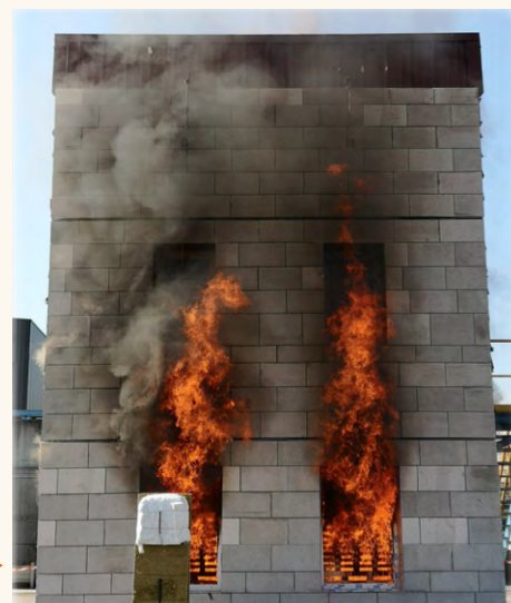
Essai LEPiR II réalisé sur une configuration générique de procédé traditionnel de revêtement mural en pierre mince attaché selon le NF DTU 55.2 Photo : CTMNC
