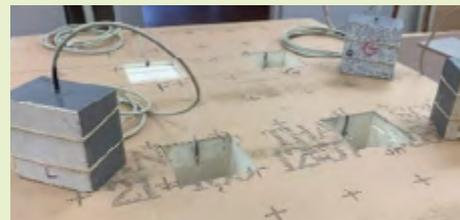
Figure : Échantillons de pierre pour la réalisation d'un essai Mosaïque du WP3 – MiMeTICS pour OEHM
