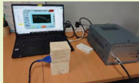
Figure 9 : Détermination de la conductivité thermique, photo CTMNC
