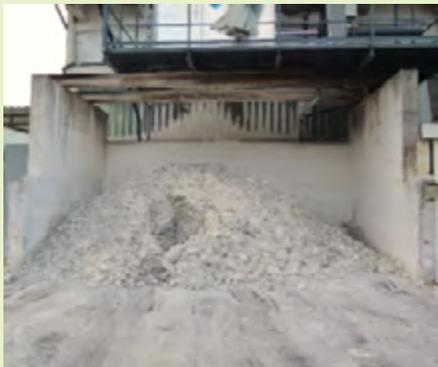
Boues de sciage en sortie de filtre presse - photo CTMNC
