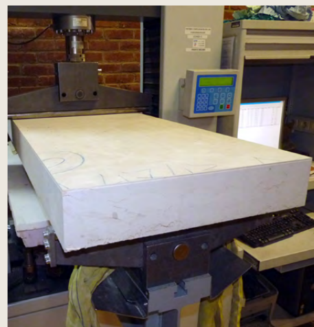
Essai de flexion grande dalle sur un granit - Photo CTMNC
