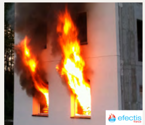
Exemple de réalisation d'un essai LEPIR II par la société Efectis France (laboratoire Les Avenières, Isère (38)) - Photo : Efectis France
