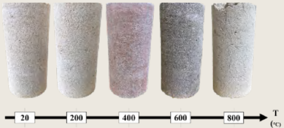
Figure 3 – Changement de couleur observé sur la pierre calcaire de Saint-Maximin chauffée à différentes températures (200, 400, 600, 800 °C). L'analyse des variations de couleur peut permettre l'estimation de la température maximale atteinte par la pierre lors d'un incendie.
