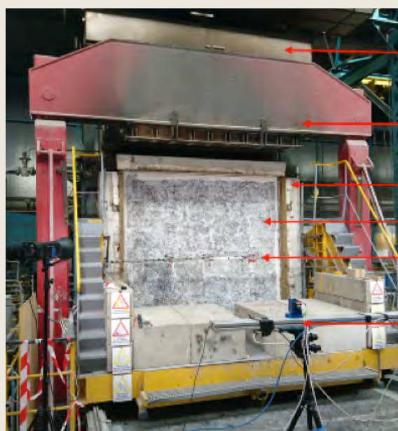
Dispositif d'essai de résistance au feu sur le mur en pierre
