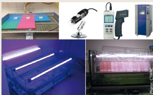
Illustration des différents essais de caractérisation des hydrofuges mis en place au laboratoire de Clamart.
