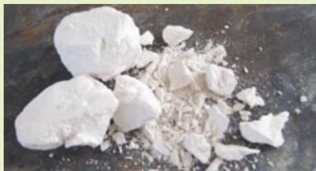
Au vu des résistances mécaniques obtenues des mortiers durcis à base de boue calcaire, l'utilisation d'un tel produit semble prometteuse en tant que **filler correcteur granulométrique** ou **addition calcaire** (potentielle substitution d'une fraction de ciment), à condition que les caractéristiques physico-chimiques répondent aux exigences des normes correspondant.
