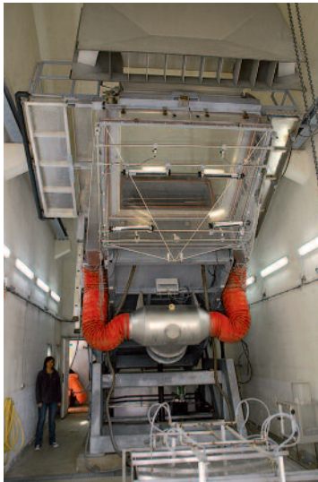
Moby Dick 2, une machine unique en France pour reproduire les conditions de vent et de pluie auxquelles sont soumises les tuiles ou les ardoises de toit.
