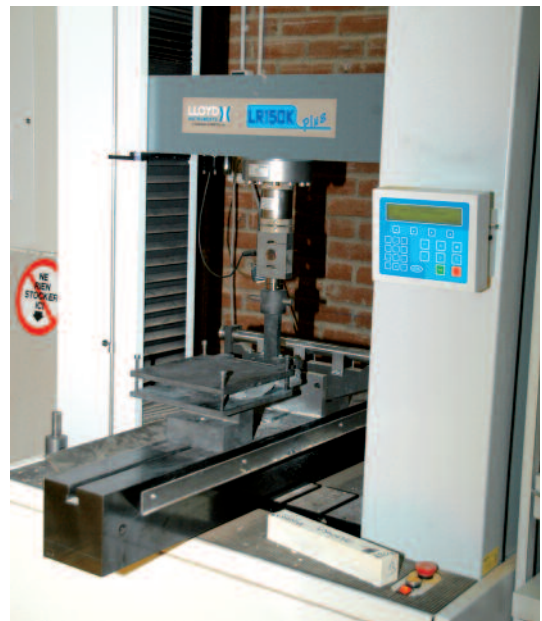
Vue générale (ci-dessus) et détail (ci-contre) d'une presse 150 KN avec accessoires permettant de réaliser des essais de flexion 3 points, flexion 4 points et résistance aux attaches..
