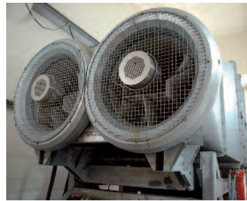
Moby Dick 2, une machine unique en France pour reproduire les conditions de vent et de pluie auxquelles sont soumises les tuiles ou les ardoises de toit.
