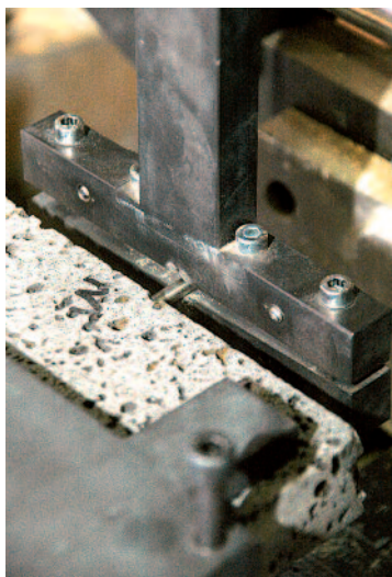
Vue générale (ci-dessus) et détail (ci-contre) d'une presse 150 KN avec accessoires permettant de réaliser des essais de flexion 3 points, flexion 4 points et résistance aux attaches..
