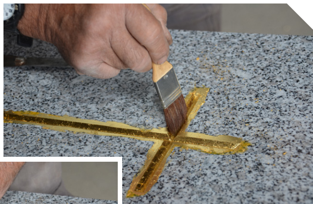
Application de la feuille d'or à l'aide du blaireau et du pinceau. Crédit photo : R. Maréchal
