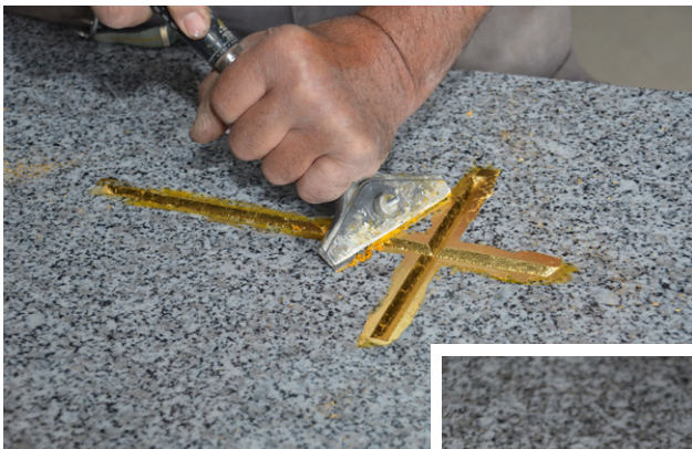
Application de la feuille d'or à l'aide du blaireau et du pinceau. Crédit photo : R. Maréchal
