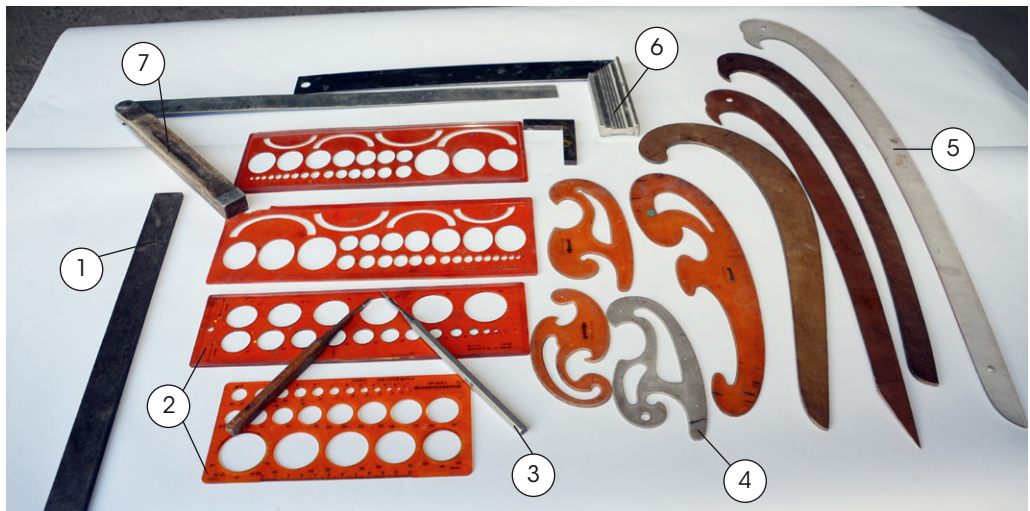
Outils pour mesures et tracés : 1-règle graduée, 2- trace cercle et ellipse, 3-pointe diamant, 4-5 règles graphiques (perroquets), 6- équerre, 7- équerre réglable / Crédit photo : R. Maréchal
