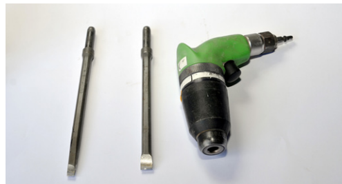
Marteau pneumatique avec ciseaux à tête adapté Crédit photo : R. Maréchal
