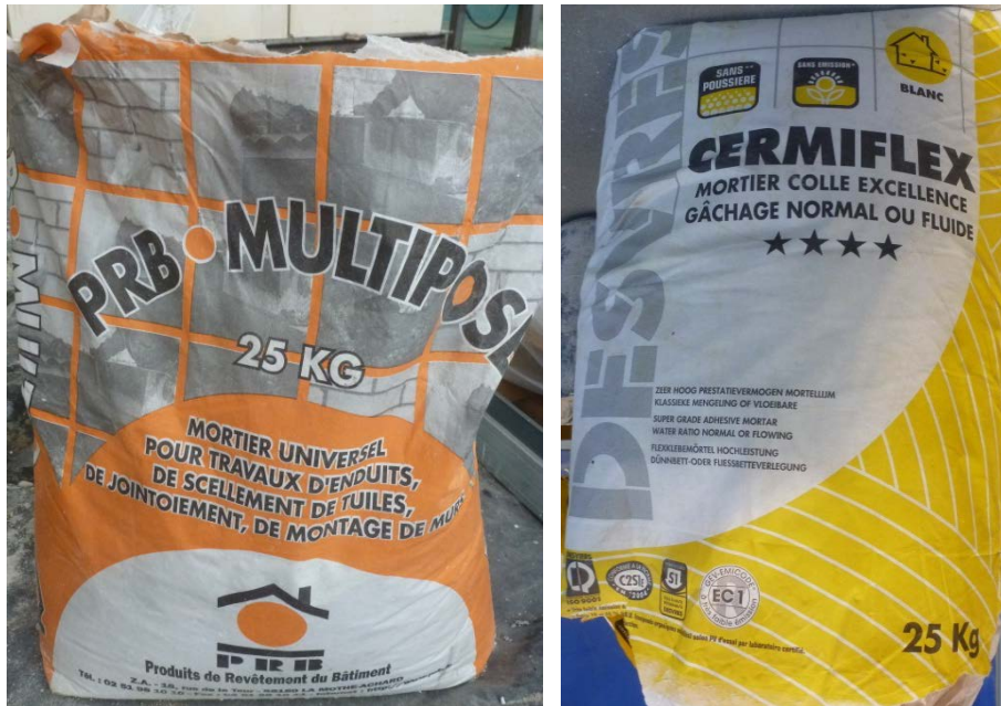
Photographies 5.2 : Vues du mortier de jointoiment et du mortier de finition
