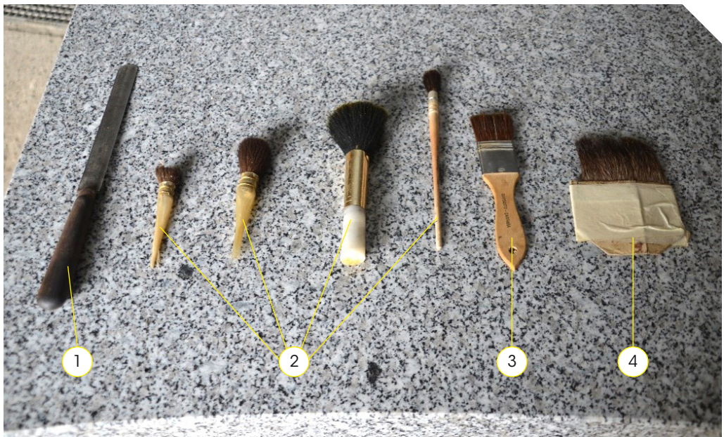
Outils pour l'application des dorures et peintures : 1- couteau, 2- blaireaux, 3- pinceau à dorure, 4- palette à dorer. Crédit photo : R. Maréchal
