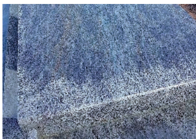
Changement d'aspect dû aux UV et à la condensation
