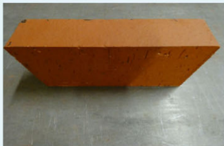
Photo n°3 : Brique U pleine (brique massive), de couleur rouge
