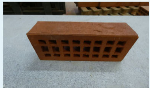
Photo n°4 : Brique U perforée (brique à perforations verticales)
